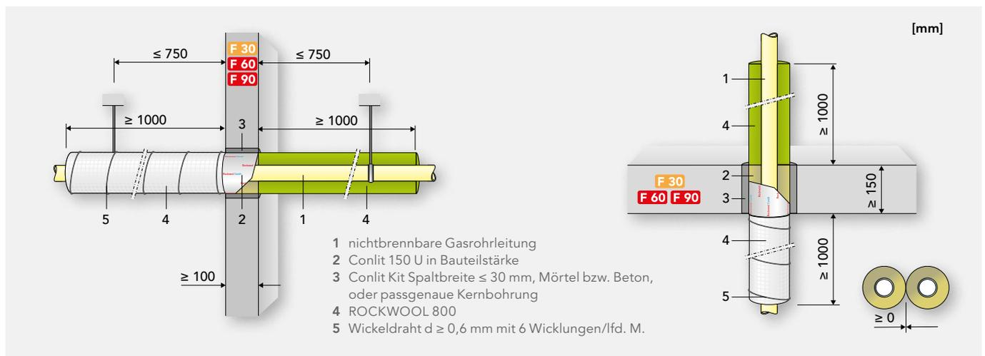
Die Ausführungen entsprechen dem ROCKWOOL abP P-3725/4130-MPA BS, Anlage 2 und 7. Alle anderen Ausführungsvarianten in diesem abP können entsprechend auch für Gasrohrleitungen angewendet werden. Rohrwerkstoffe/Dimensionen siehe Tabellen auf Seite 68.
