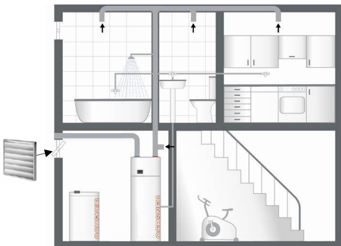
Abbildung 3: Aufstellung mit Heizungswärmepumpe mit Fortluftklappe
