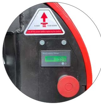
Batterieladestand- und Betriebsstundenanzeige mit Not-Aus-Knopf
