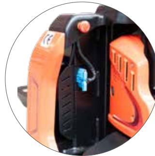
Akkuanschluss mit Not-Aus-Knopf
