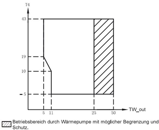
Im Heizmodus ist der Bereich der Wasservorlauftemperatur (TW\_out) bei unterschiedlicher Außentemperatur (T4) unten aufgeführt:
