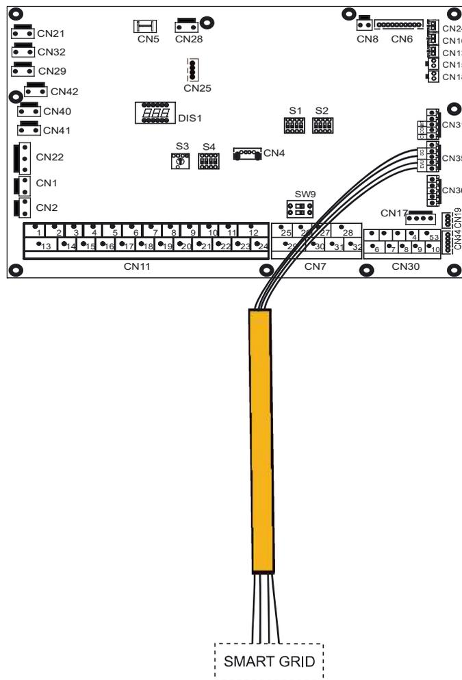
1. Wenn das EVU-Signal und das SG-Signal aktiv sind, wird die Wärmepumpe, solange der WW-Modus Priorität gültig ist, vorrangig im WW-Modus betrieben und die Einstelltemperatur des WW-Modus wird auf 70 °C geändert,  $T_5 < 69$  °C, TBH ist eingeschaltet,  $T_5 \geq 70$  °C, TBH ist ausgeschaltet.
