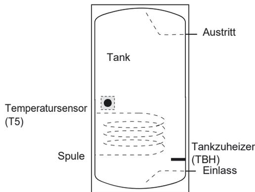
Der Tankzuheizer muss unterhalb des Temperatursensors (T5) installiert werden.
