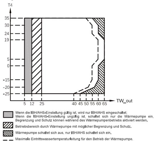
Im WW-Modus ist der Bereich der Wasservorlauftemperatur (TW\_out) bei unterschiedlicher Außentemperatur (T4) unten aufgeführt:
