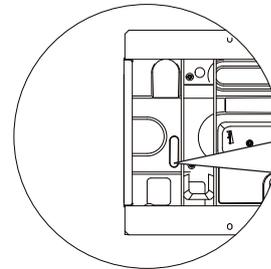
Dieses Ablaufloch ist mit einem Gummistopfen abgedeckt. Wenn das kleine Ablaufloch die Anforderungen an die Entwässerung nicht erfüllen kann, kann gleichzeitig das große Ablaufloch verwendet werden.
