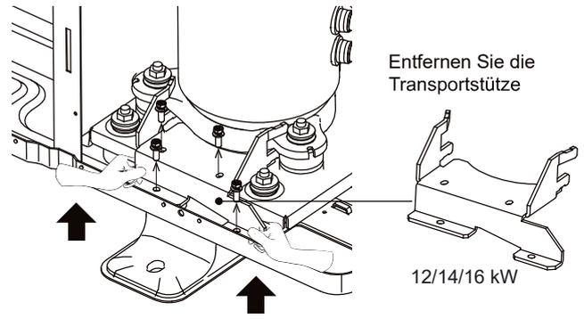
Entfernen Sie die Transportstütze
