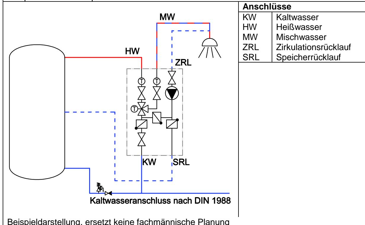
Beispiel Kombipufferspeicher mit internem Trinkwasserwärmetauscher
