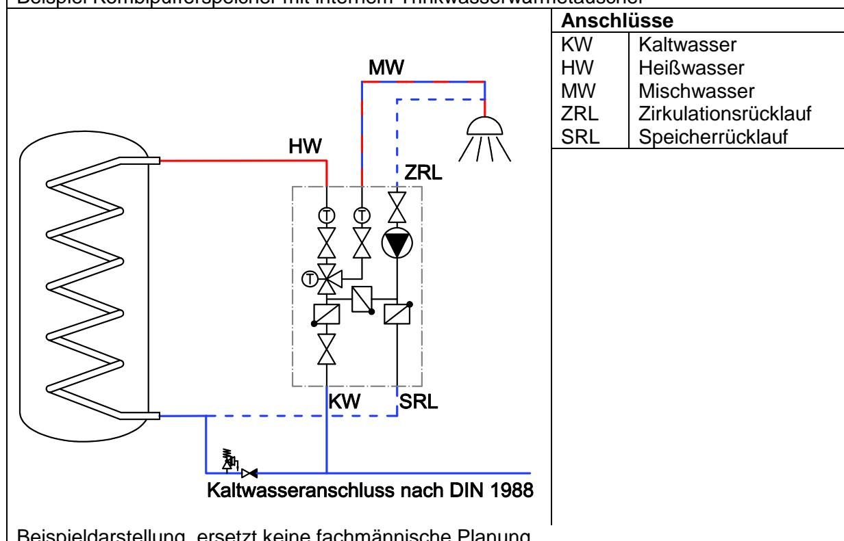
Beim Eindrehen der Anschlüsse die jeweiligen Bauteile gegen Verdrehen sichern und entsprechend gegenhalten.
